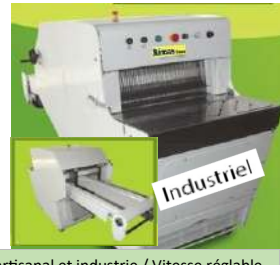
AUTOMATIQUE artisanal et industrie / Vitesse réglable / alimentation manuelle ou par goulotte en gravité, sortie sur tapis de réception
